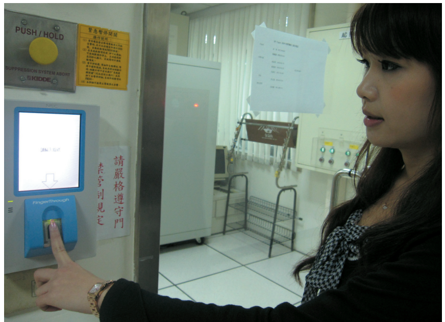
▲ 在所有生物辨識技術中，以指紋辨識技術最適合應用在門禁管制系統，其好處在於應用範圍廣、沒有太大的侵入性、且操作容易。(NEC提供)
