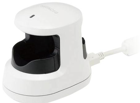
圖6 Hitachi PC系統登錄用PCT-KC8203指靜脈辨識裝置。
